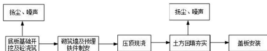
图 2-4 电缆工井施工流程图
