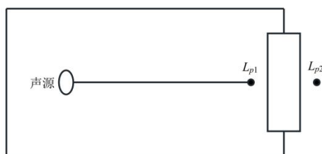
图 4-3 室内声源等效为室外声源图例
