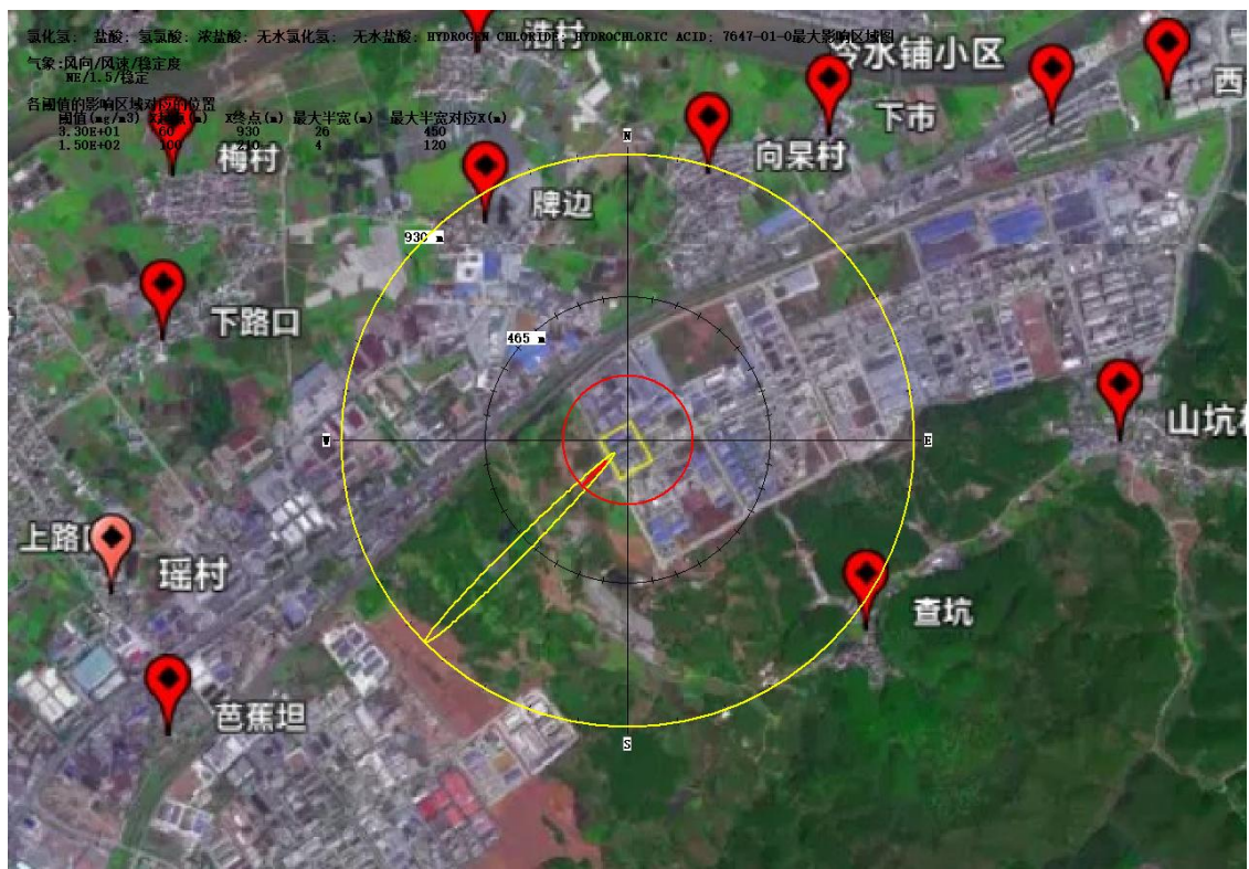
图 5.7-4 最不利气象条件下火灾伴生 HCl 排放预测结果图(最大影响范围示意图)
